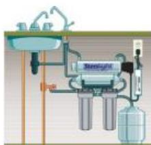
Al incorporar tanto un Cartucho de sedimentos y otro de carbón Activado de pre-filtro, con un sistema de desinfección UV todos los problemas del agua se pueden resolver con un solo equipo.
