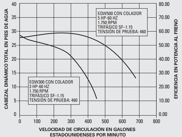
Para conocer las curvas de eficiencia detalladas para cada modelo, póngase en contacto con la fábrica.
